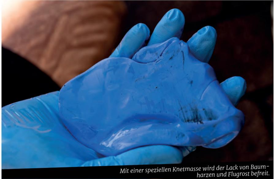
Mit einer speziellen Knetmasse wird der Lack von Baumharzen und Flugrost befreit.
