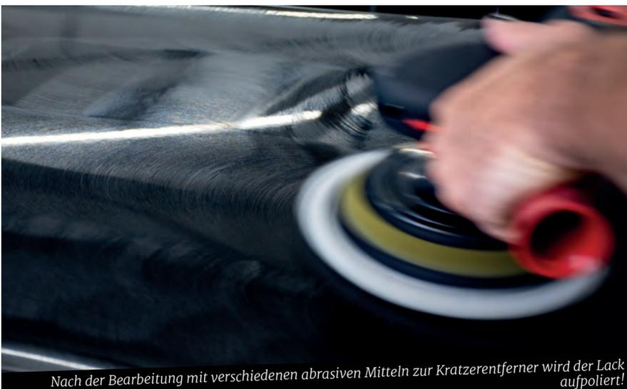
Nach der Bearbeitung mit verschiedenen abrasiven Mitteln zur Kratzerentfernung wird der Lack aufpoliert!
