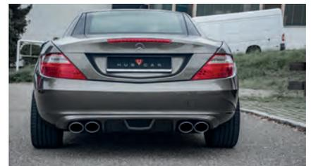
Die HUB CAR-Auspuffanlagen für den SLK R170 verfügen jeweils über einen Endschalldämpfer, welcher mit Endrohren in zwei Größen im Originaldesign zu haben ist, die jeweils ohne Bearbeitung derselben in die originale Heckschürze passen.
